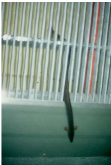
Ein 70 cm langer Aal passiert einen 20 mm-Rechen
