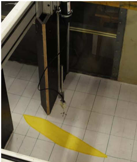
Auf die Sohle der Laborrinne gezeichnete Vena contracta mit 1,5 m/s (Foto: IfÖ 2010)
